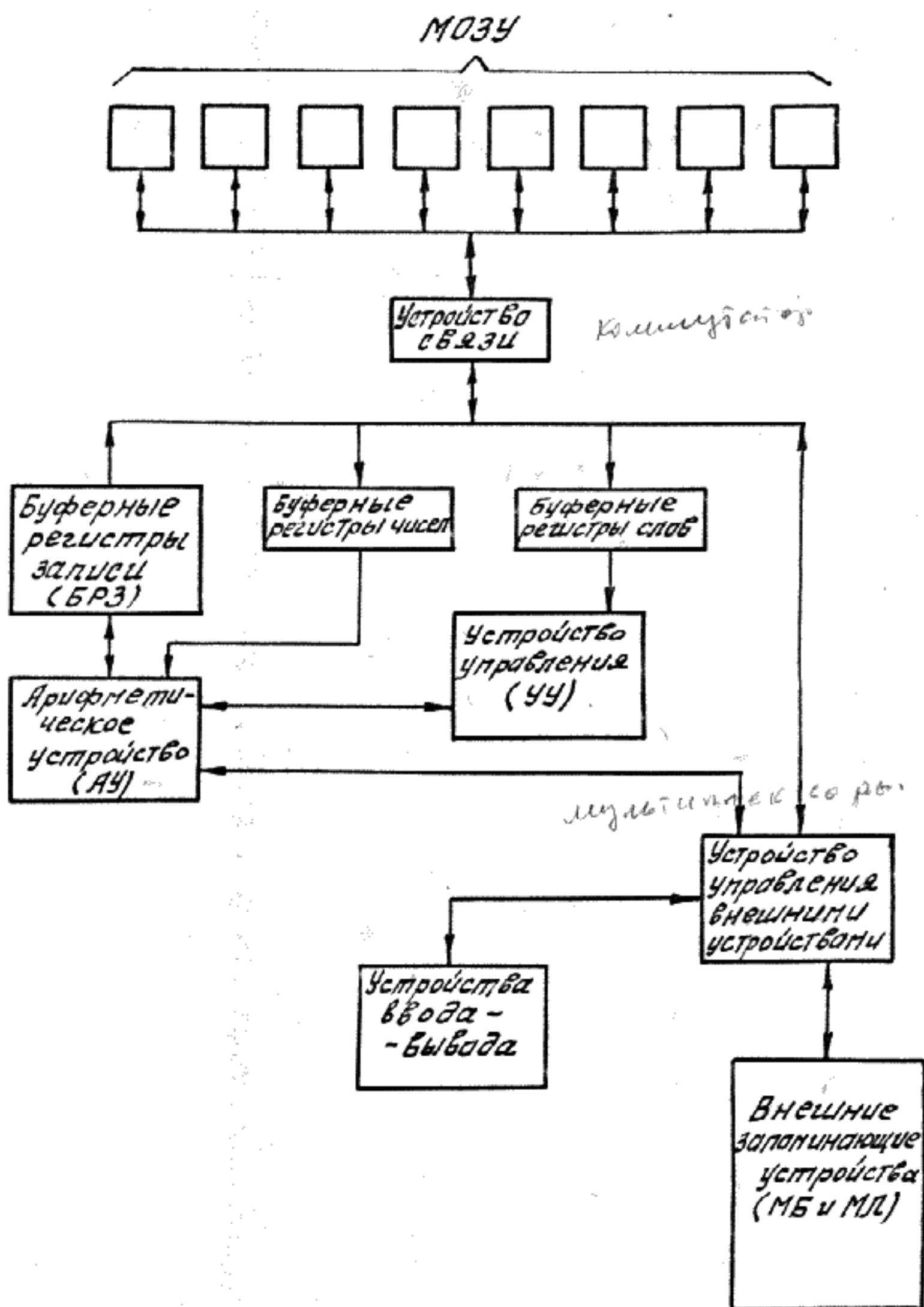
Рис. 1.1. Блок-схема машины
